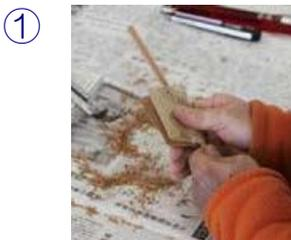
① サンドペーパーを使って、箸の先が細くなるように削る。
